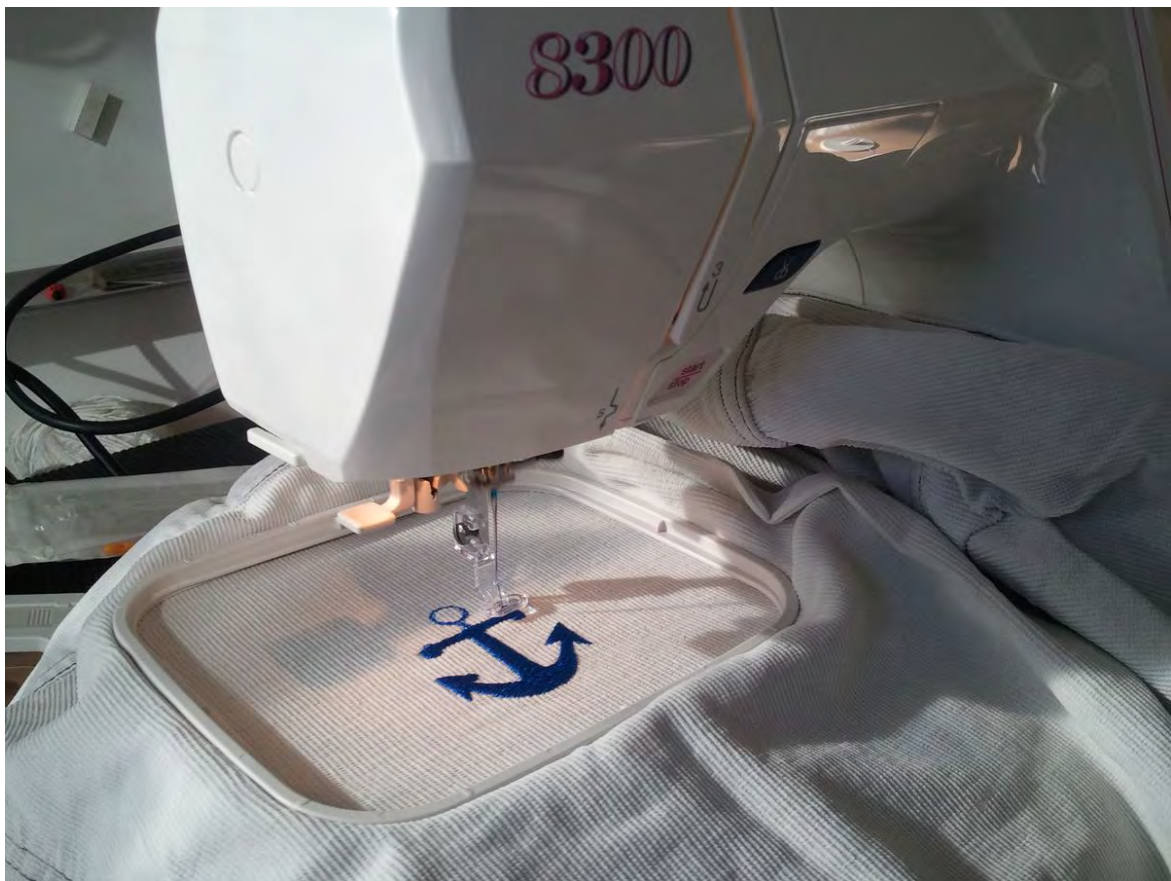
Cadre à broder "Hoop A" pour Elna 8300. Le cadre est attaché au pantographe avec un seul point
